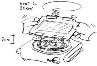
5 put the frame on the vacuum forming box quickly. 素早くフレームをバキューム ボックスの上に置く。
