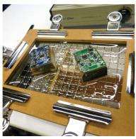
6 Vacuum until PVC cools down. 塩ビ板がさめるまで掃除機で吸引する。
